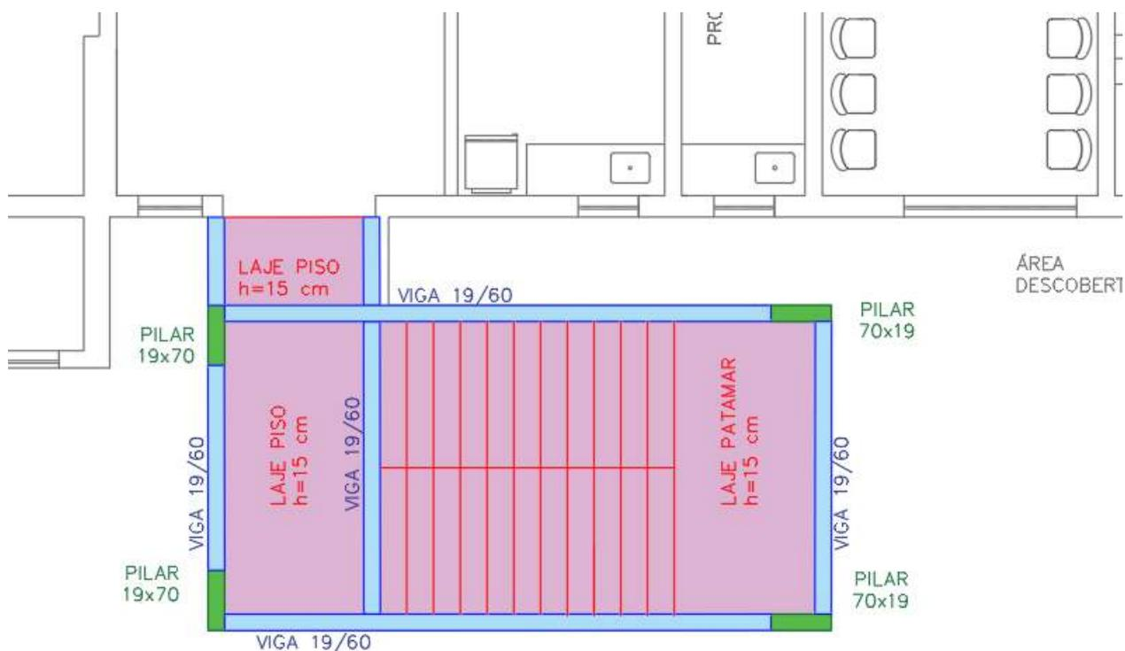
Figura 27 - PRÉDIO AMBULATÓRIO – 1º PAVIMENTO – ESCADA 02 - Croqui estrutura
