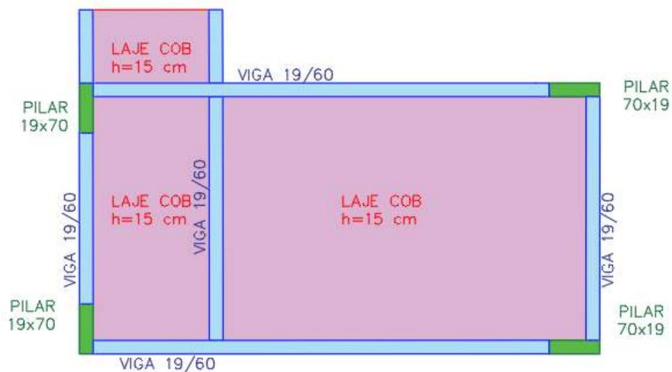
Figura 36 - PRÉDIO AMBULATÓRIO – COBERTURA DA ESCADA – ESCADA 03 - Croqui estrutura
