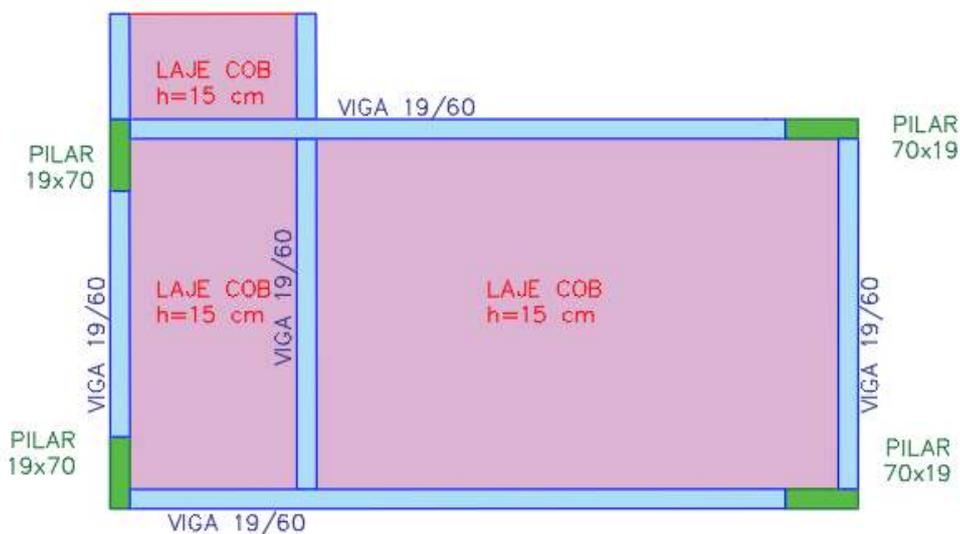
Figura 29 - PRÉDIO AMBULATÓRIO – COBERTURA DA ESCADA – ESCADA 02 - Croqui estrutura
