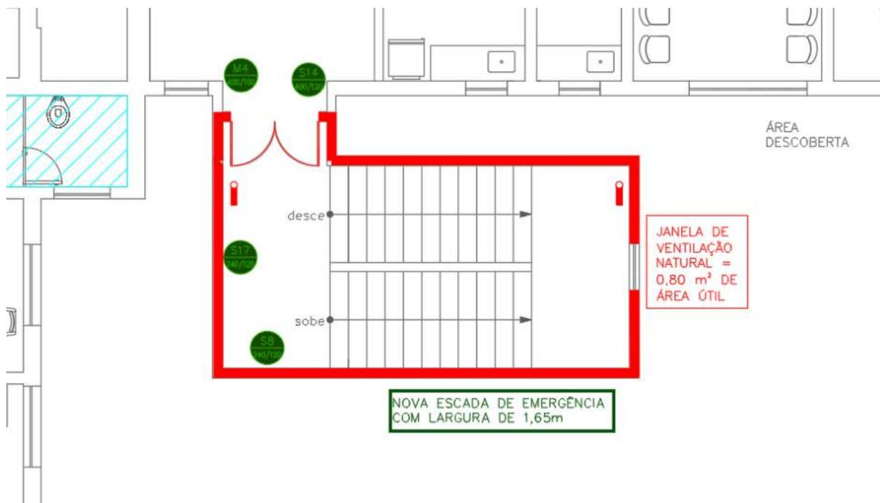
Figura 24 – PRÉDIO AMBULATÓRIO – 1º PAVIMENTO – ESCADA 02 - Layout Nova escada
