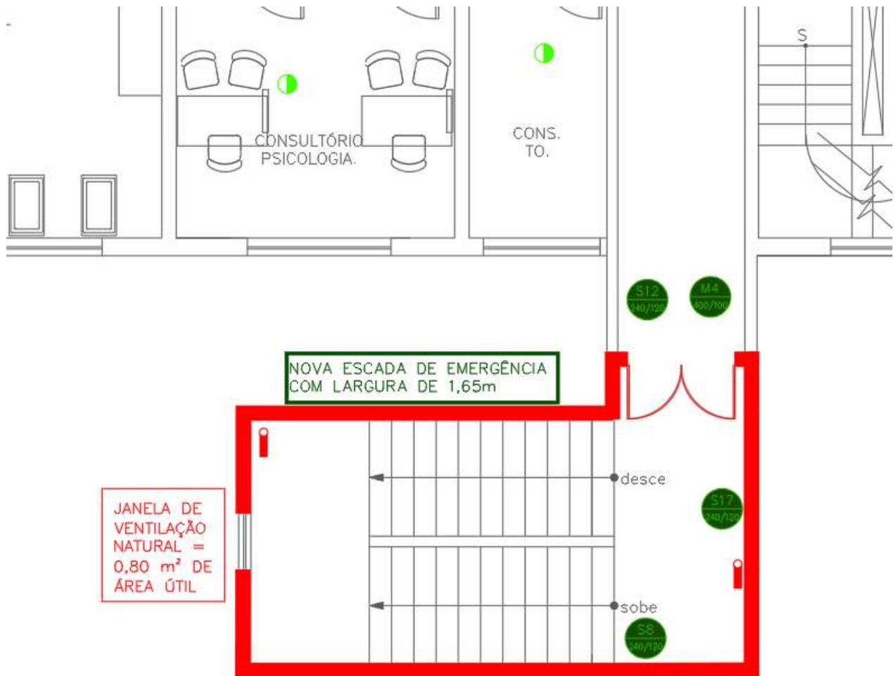
Figura 16 – PRÉDIO AMBULATÓRIO – 1º PAVIMENTO – ESCADA 01 - Layout Nova escada
