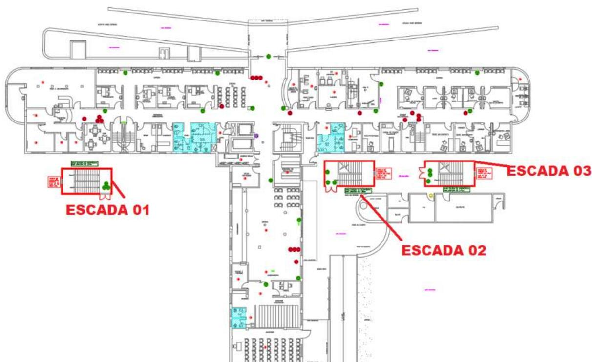
Figura 13 – PRÉDIO AMBULATÓRIO - PAVIMENTO TÉRREO– locação das novas escadas
