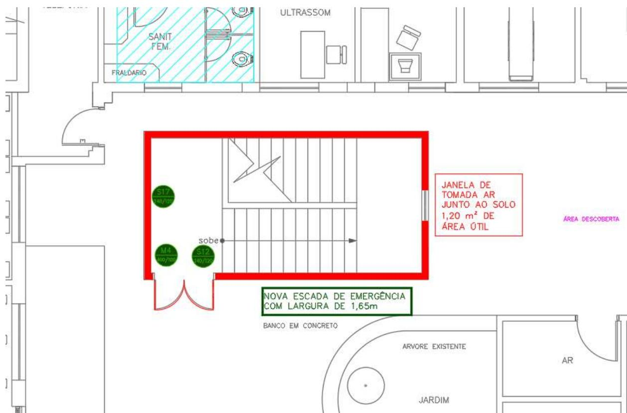
Figura 23 – PRÉDIO AMBULATÓRIO - PAVIMENTO TÉRREO – ESCADA 02 – Layout Nova escada (sem acesso)
