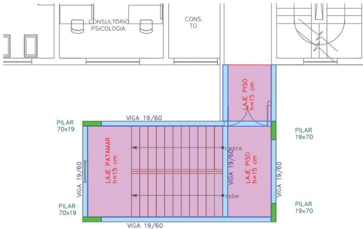
Figura 20 - PRÉDIO AMBULATÓRIO – 1º PAVIMENTO – ESCADA 01 - Croqui estrutura
