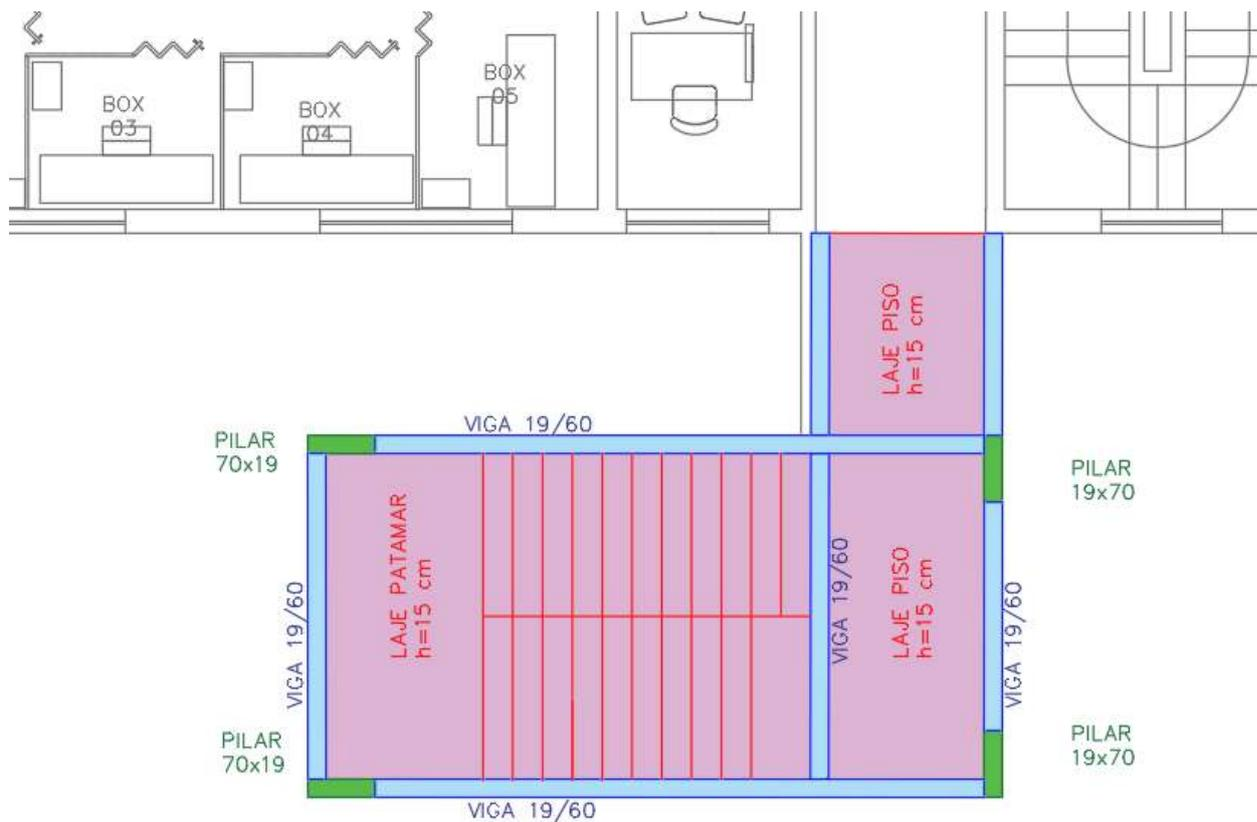
Figura 21 - PRÉDIO AMBULATÓRIO – 2º PAVIMENTO – ESCADA 01 - Croqui estrutura
