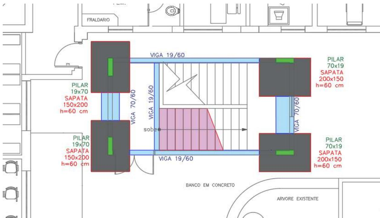
Figura 26 - PRÉDIO AMBULATÓRIO – PAVIMENTO TÉRREO- ESCADA 02 - Croqui estrutura
