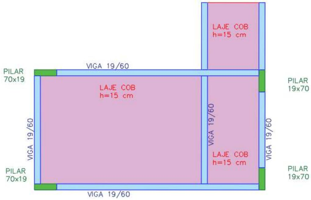
Figura 22 - PRÉDIO AMBULATÓRIO – COBERTURA DA ESCADA – ESCADA 01 - Croqui estrutura
