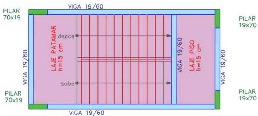
Figura 19 - PRÉDIO AMBULATÓRIO – PAVIMENTO TÉRREO– ESCADA 01 - Croqui estrutura
