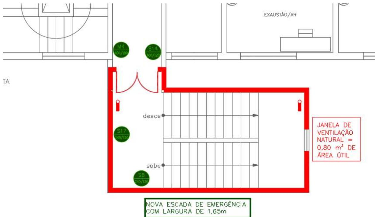
Figura 31 – PRÉDIO AMBULATÓRIO – 1º PAVIMENTO – ESCADA 03 - Layout Nova escada
