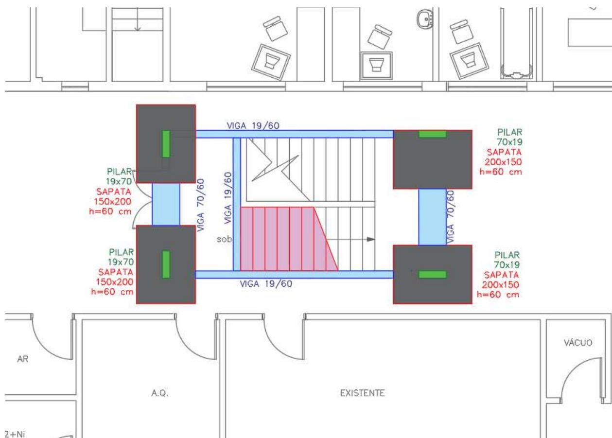
Figura 33 - PRÉDIO AMBULATÓRIO – PAVIMENTO TÉRREO– ESCADA 03 - Croqui estrutura
