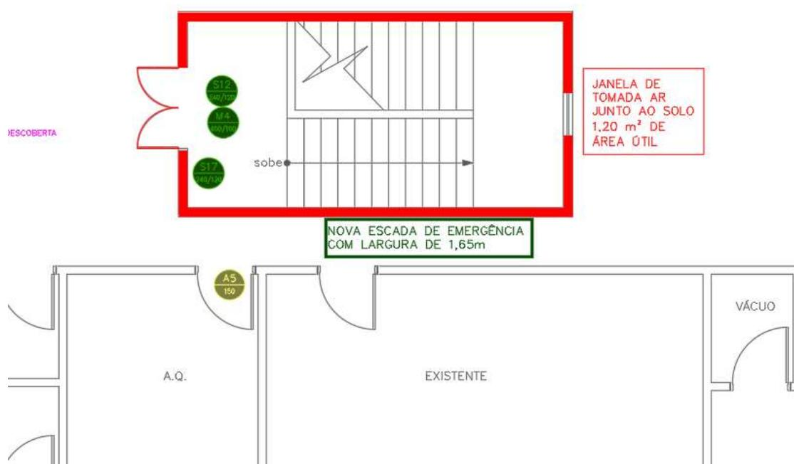
Figura 30 – PRÉDIO AMBULATÓRIO - PAVIMENTO TÉRREO – ESCADA 03 – Layout Nova escada (sem acesso)
