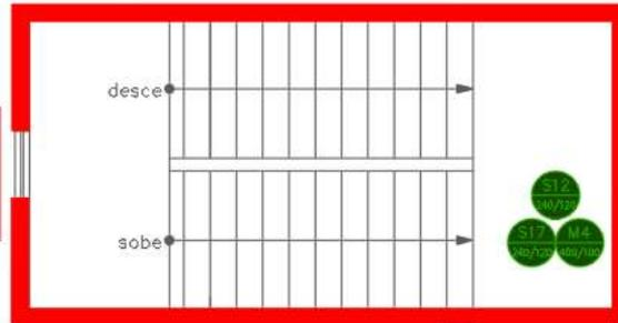
Figura 14 – PRÉDIO AMBULATÓRIO - SUBSOLO – ESCADA 01 – Layout Nova escada
