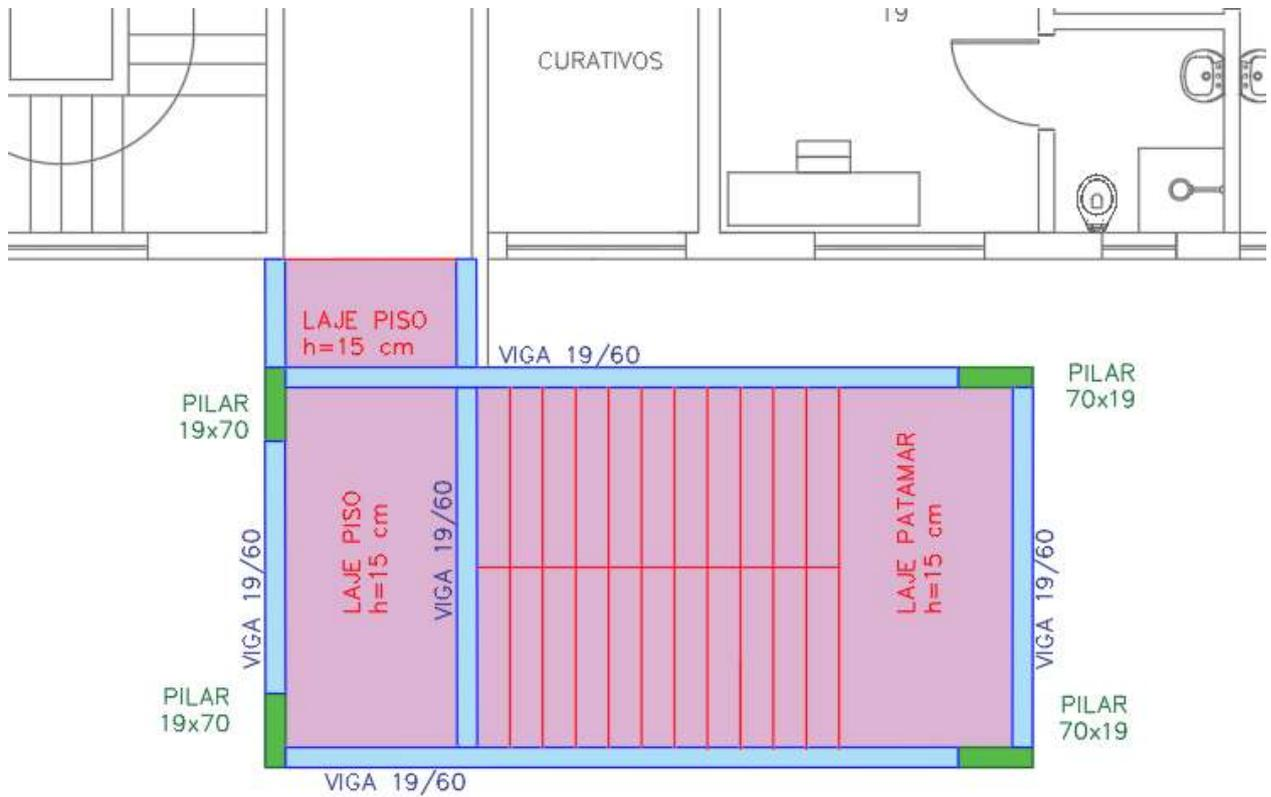
Figura 35 - PRÉDIO AMBULATÓRIO – 2º PAVIMENTO – ESCADA 03 - Croqui estrutura
