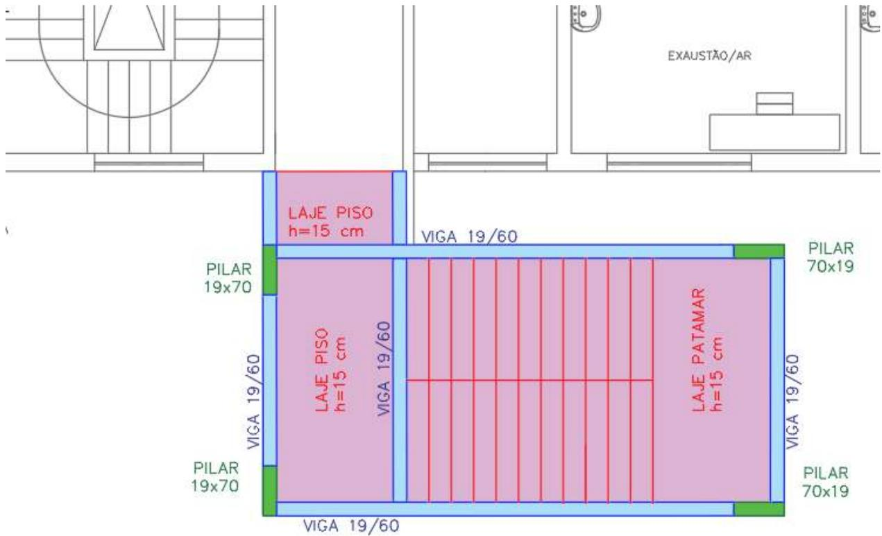
Figura 34 - PRÉDIO AMBULATÓRIO – 1º PAVIMENTO – ESCADA 03 - Croqui estrutura
