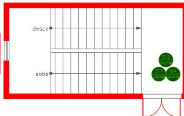
Figura 15 – PRÉDIO AMBULATÓRIO - PAVIMENTO TÉRREO – ESCADA 01 – Layout Nova escada (sem acesso)
