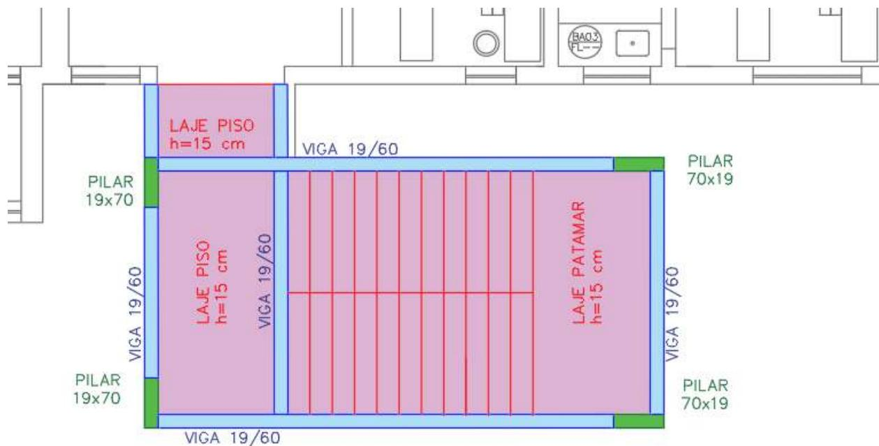
Figura 28 - PRÉDIO AMBULATÓRIO – 2º PAVIMENTO – ESCADA 02 - Croqui estrutura
