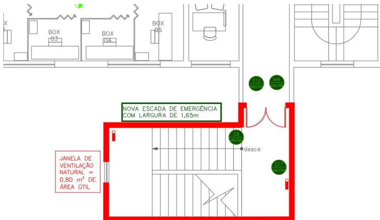
Figura 17 – PRÉDIO AMBULATÓRIO – 2º PAVIMENTO – ESCADA 01 - Layout Nova escada
