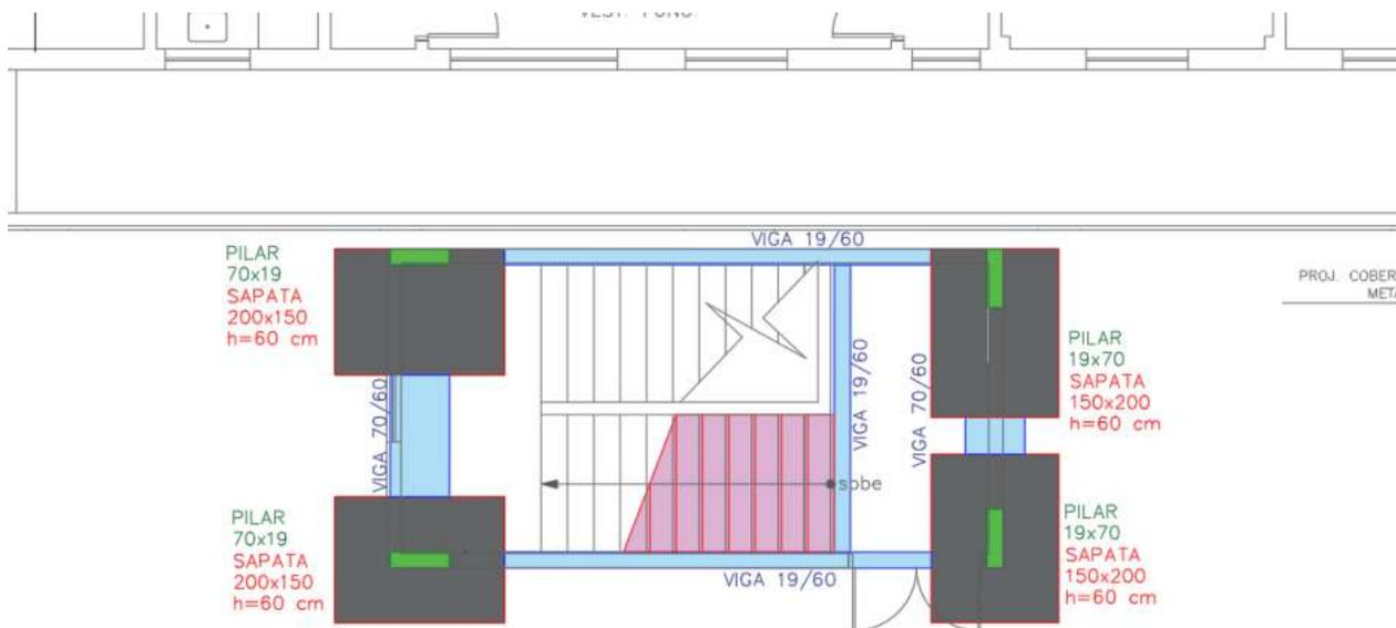
Figura 18 - PRÉDIO AMBULATÓRIO –SUBSOLO – ESCADA 01 - Croqui estrutura
