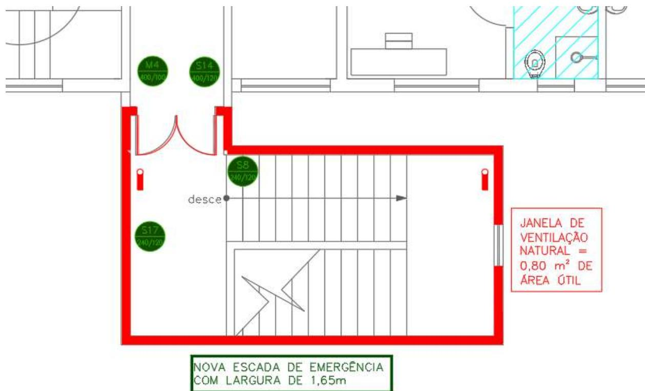
Figura 32 – PRÉDIO AMBULATÓRIO – 2º PAVIMENTO – ESCADA 03 - Layout Nova escada
