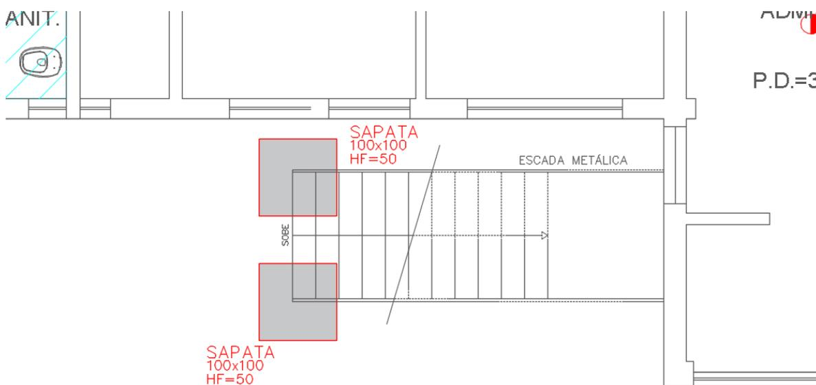
Figura 32 –PAVIMENTO TÉRREO - ENFERMARIA – Croqui fundação da nova escada metálica externa 2 (central)
