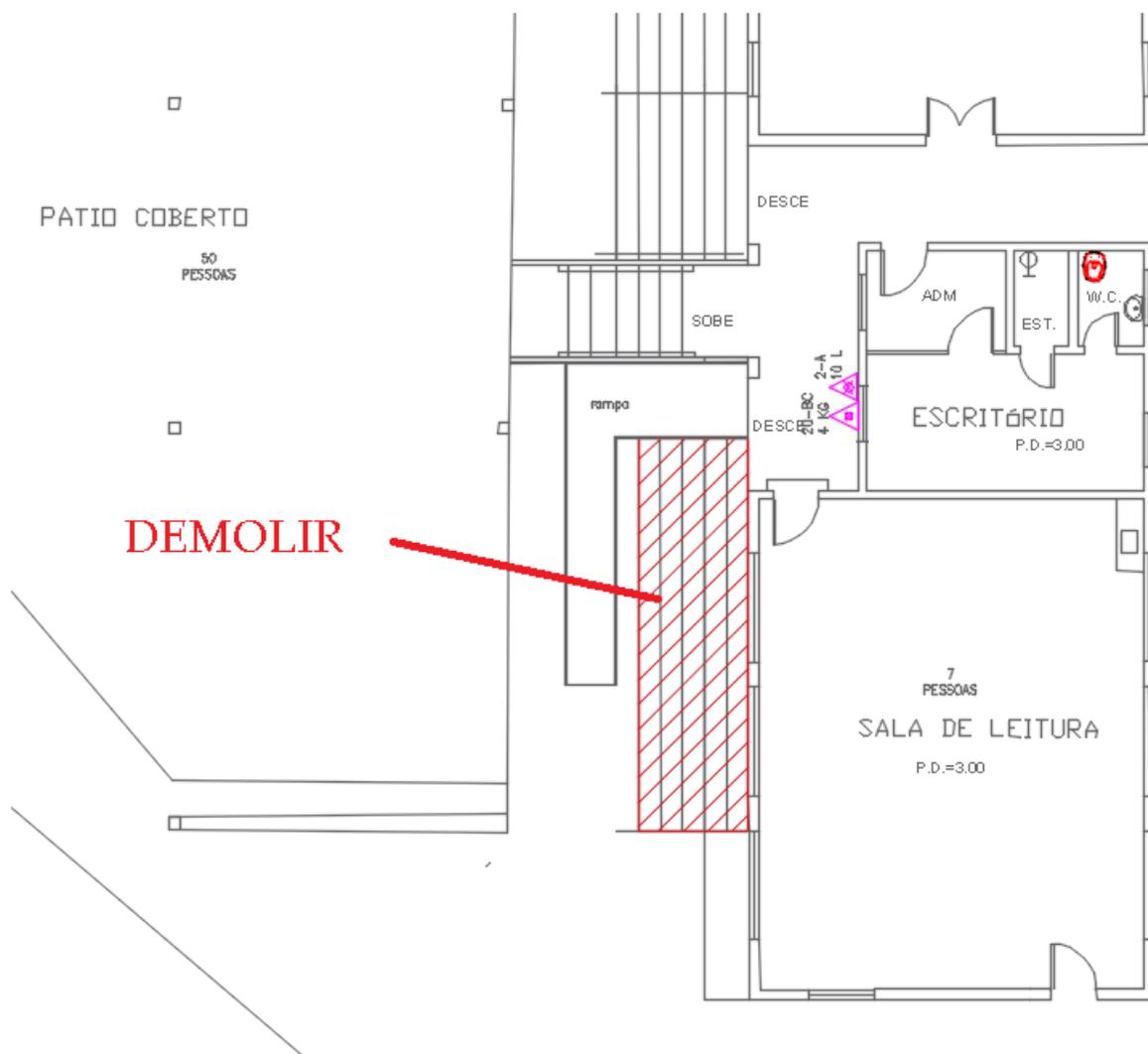
Figura 22 – PAVIMENTO TÉRREO – CENTRO DE CONVIVÊNCIA – Demolição escada para ampliação da rampa
