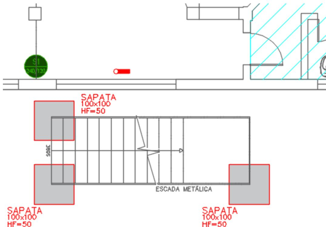
Figura 33 –PAVIMENTO TÉRREO - ENFERMARIA – Croqui fundação da nova escada metálica externa 3 (direita)
