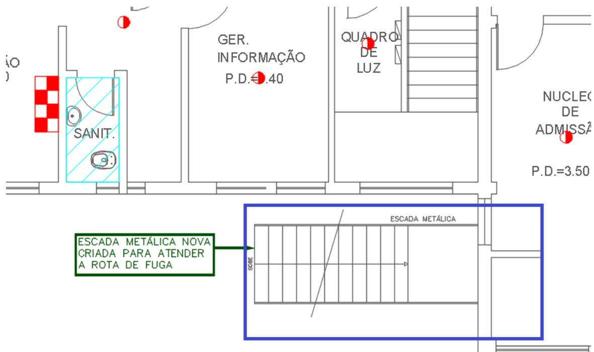
Figura 27 –PAVIMENTO TÉRREO - ENFERMARIA – Nova escada metálica externa 2 (central)
