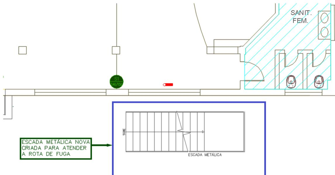
Figura 29 –PAVIMENTO TÉRREO - ENFERMARIA – Nova escada metálica externa 3 (direita)
