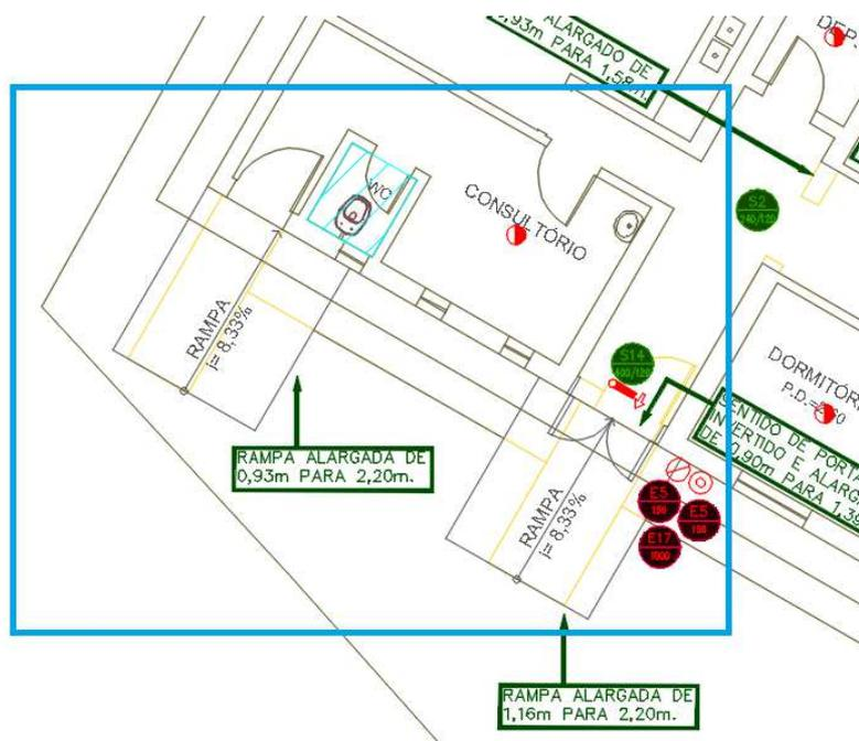
Figura 19 –PAVIMENTO TÉRREO – DEPENDÊNCIA QUÍMICA – Ampliações da rampa – Rampa existente (amarelo) x nova rampa
