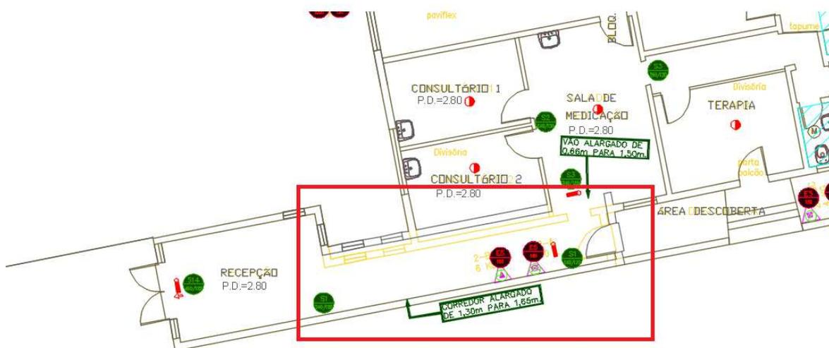
Figura 13 –PAVIMENTO TÉRREO - PORTARIA, VESTIÁRIOS, PATRIMÔNIO E MED. DO TRAB.– Demolição/reconstrução linha de parede do corredor
