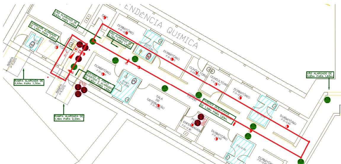
Figura 15 –PAVIMENTO TÉRREO – DEPENDÊNCIA QUÍMICA – Demolição/reconstrução linha de parede do corredor
