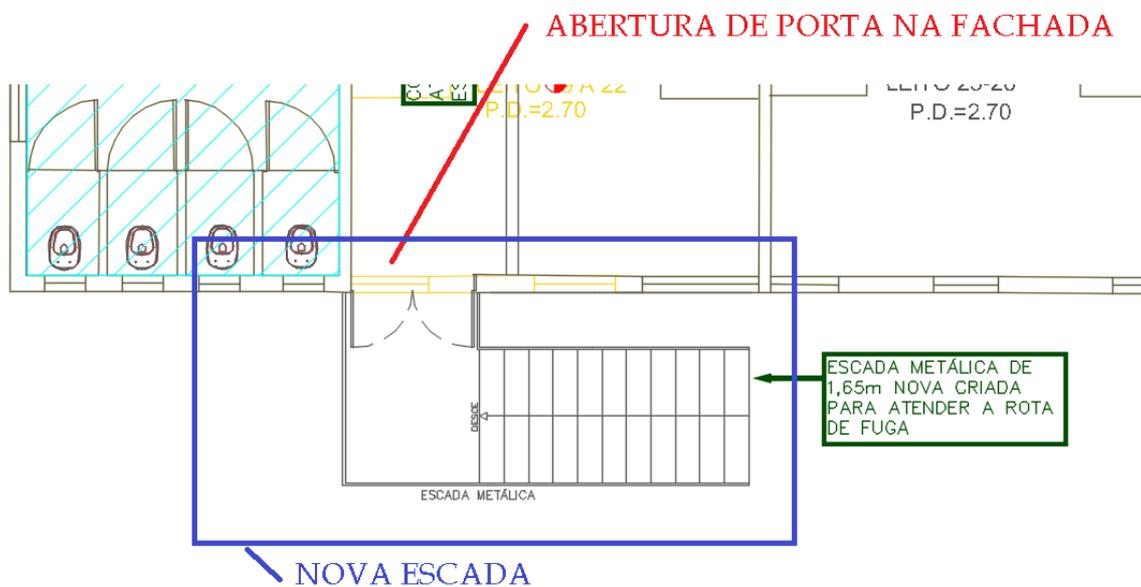
Figura 26 –PAVIMENTO SUPERIOR - ENFERMARIA – Nova escada metálica externa 1 (esquerda)
