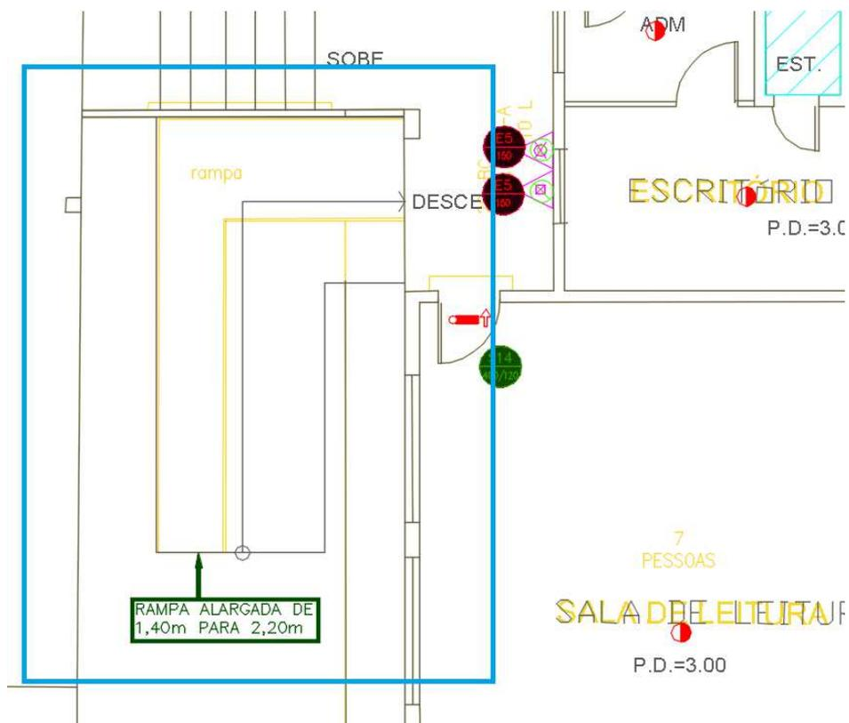
Figura 23 – PAVIMENTO TÉRREO – CENTRO DE CONVIVÊNCIA – Ampliação da rampa - Rampa antiga (amarelo) x Nova rampa
