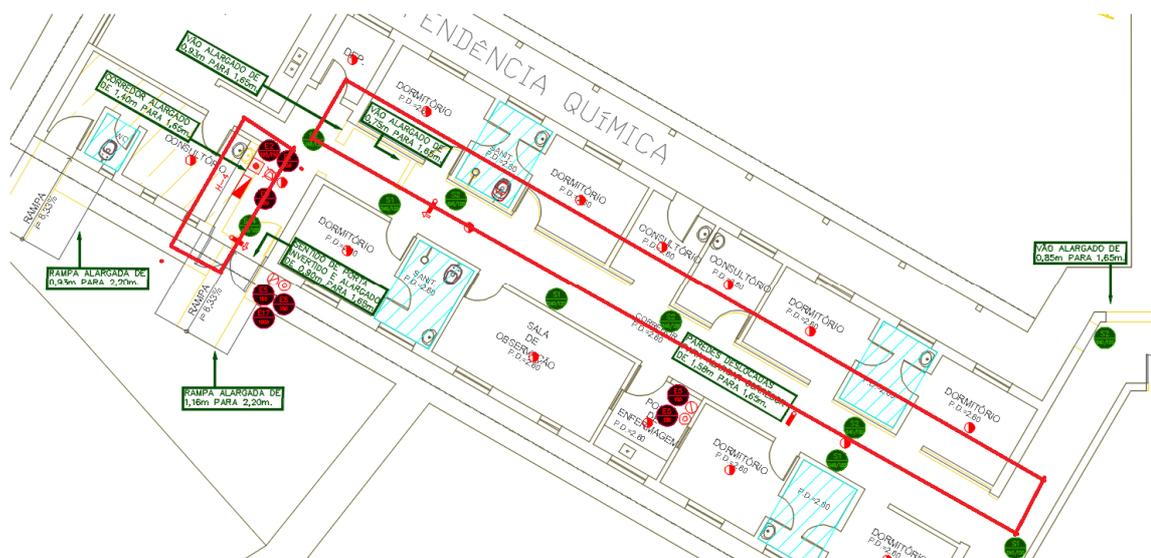
Figura 21 –PAVIMENTO TÉRREO – DEPENDÊNCIA QUÍMICA – Ampliação do corredor, estrutura antiga (amarelo) x nova estrutura
