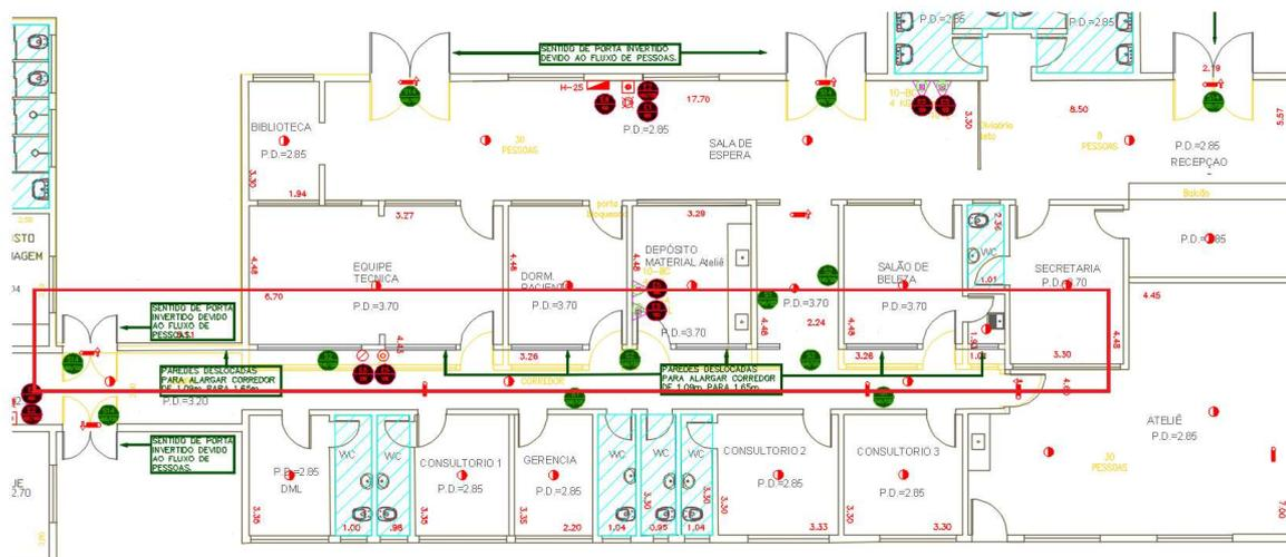
Figura 14 –PAVIMENTO TÉRREO –HOSPITAL DIA– Demolição/reconstrução linha de parede do corredor
