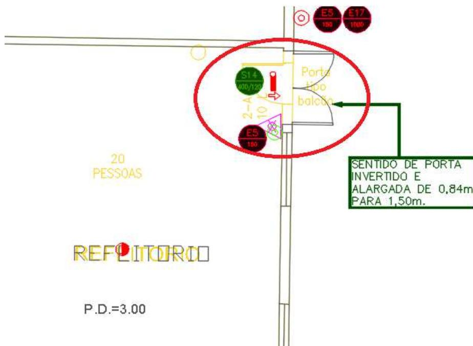
Figura 6 – PAVIMENTO TÉRREO – ALMOXARIFADO, MARCENARIA E LIMPEZA – Remoção/Instalação de nova porta
