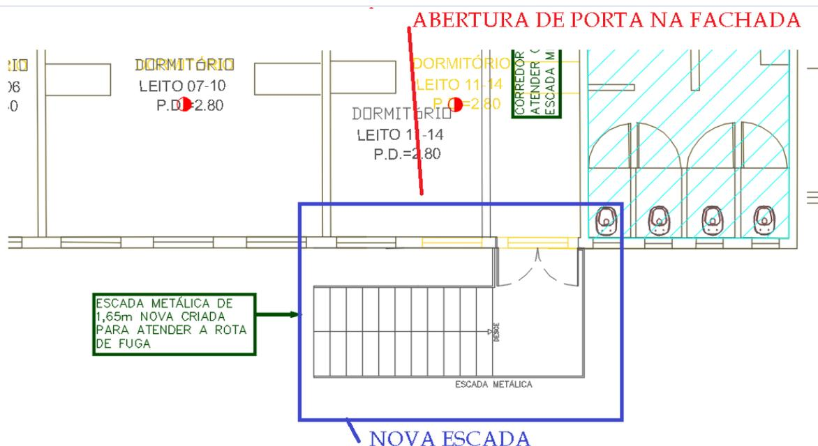
Figura 30 –PAVIMENTO SUPERIOR - ENFERMARIA – Nova escada metálica externa 3 (direita)
