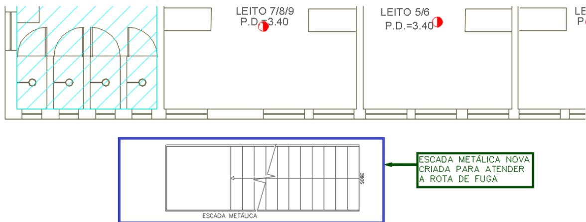
Figura 25 –PAVIMENTO TÉRREO - ENFERMARIA – Nova escada metálica externa 1 (esquerda)
