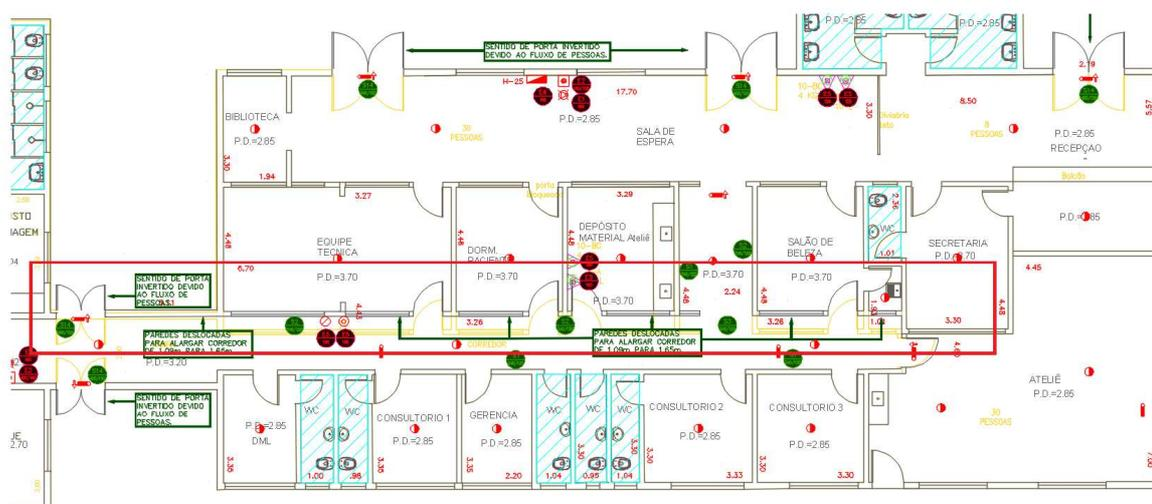
Figura 17 –PAVIMENTO TÉRREO –HOSPITAL DIA– Ampliação do corredor, estrutura antiga (amarelo) x nova estrutura
