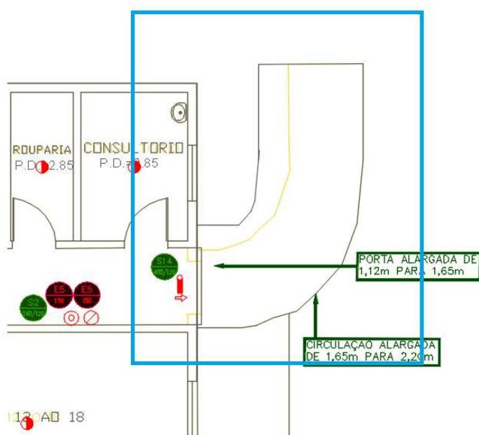
Figura 20 –PAVIMENTO TÉRREO – DEPENDÊNCIA QUÍMICA – Ampliação da circulação - Circulação existente (amarelo) x nova circulação
