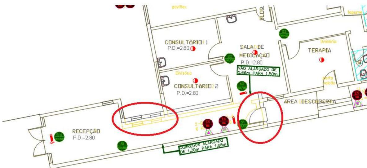
Figura 7 –PAVIMENTO TÉRREO - PORTARIA, VESTIÁRIOS, PATRIMÔNIO E MED. DO TRAB.– Remover e reinstalar porta e janela no novo alinhamento da parede
