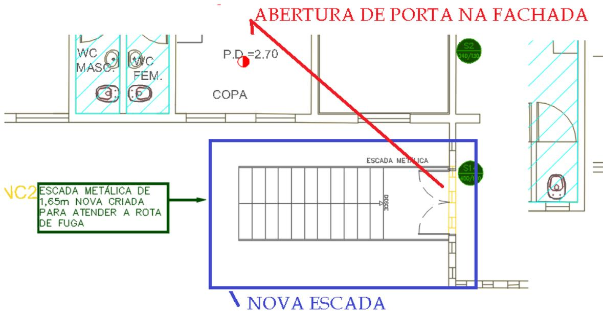
Figura 28 –PAVIMENTO SUPERIOR - ENFERMARIA – Nova escada metálica externa 2 (central)
