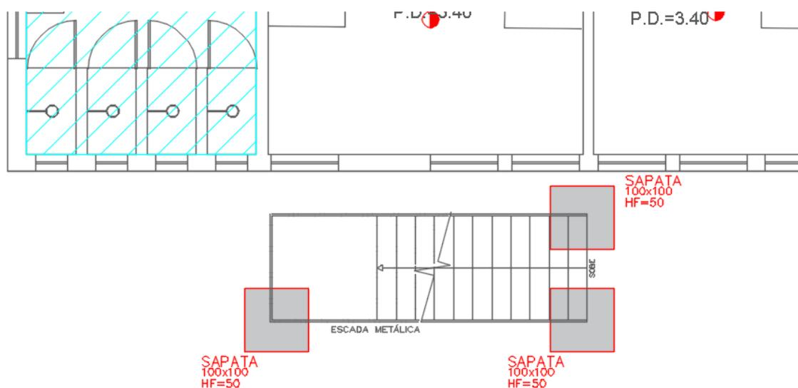
Figura 31 –PAVIMENTO TÉRREO - ENFERMARIA – Croqui fundação da nova escada metálica externa 1 (esquerda)
