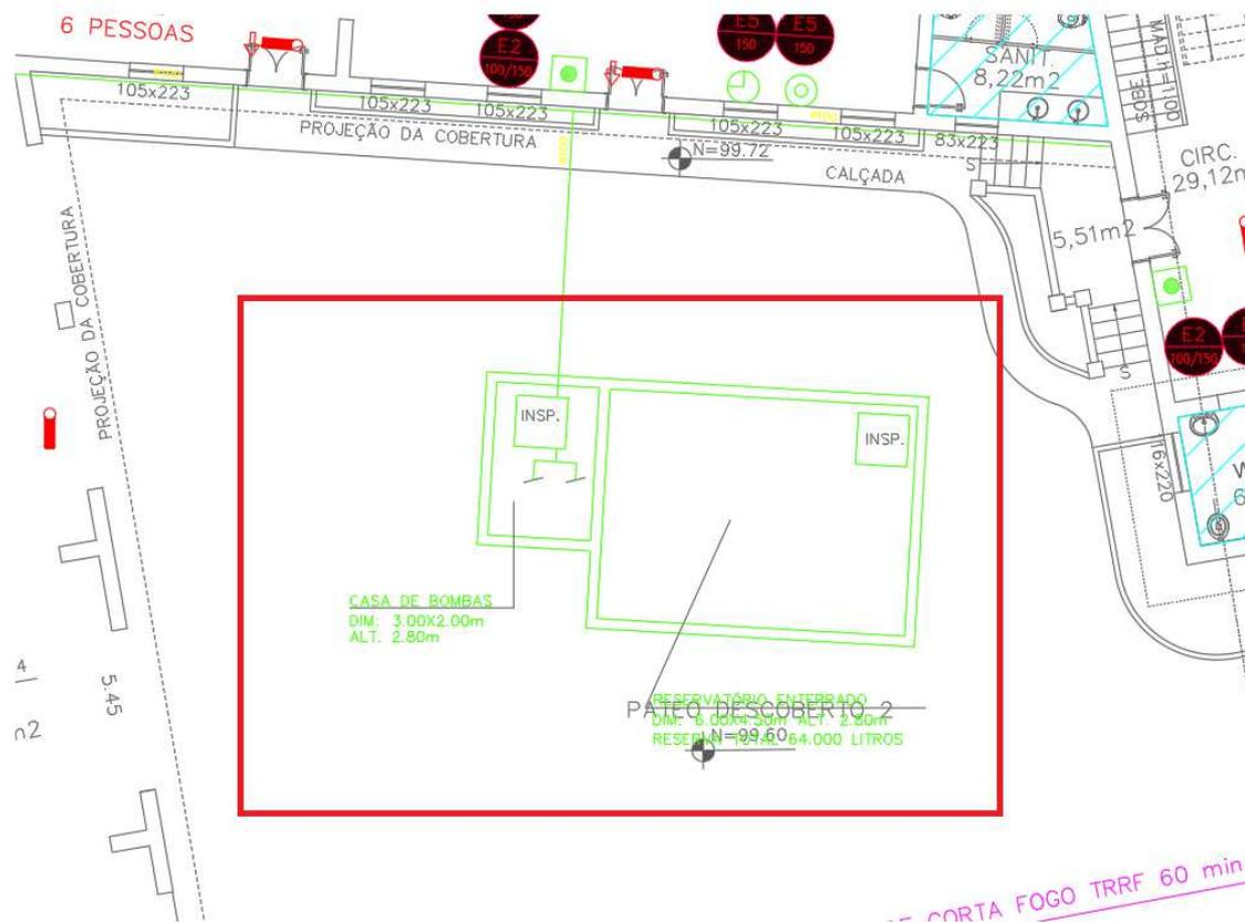
Figura 17 –RESERVATÓRIO E CASA DE BOMBAS – Layout
