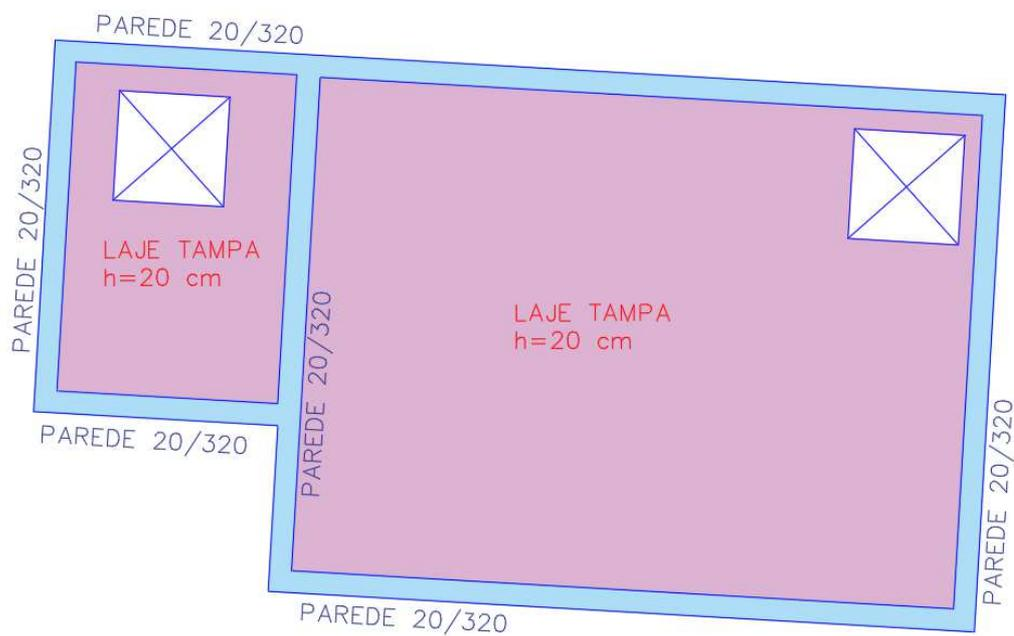
Figura 19 – TAMPA RESERVATÓRIO E CASA DE BOMBAS – Croqui estrutura
