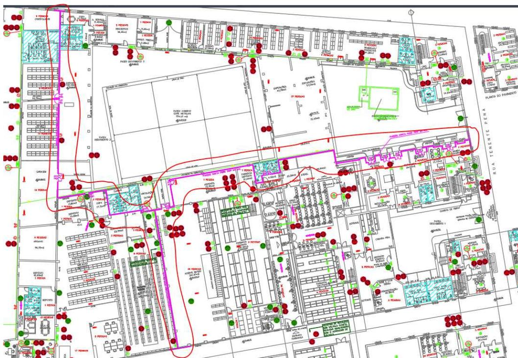
Figura 2 – TÉRREO – Paredes corta-fogo
