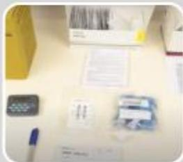
Superfície plana (sem irregularidades) e com cobertura de papel absorvente para disposição dos materiais e evitar contaminação do local de trabalho
