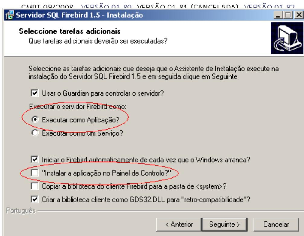
Tela do instalador onde deve-se MARCAR como APLICAÇÃO a forma como o servidor vai operar e DESMARCAR a instalação no Painel de Controle.
