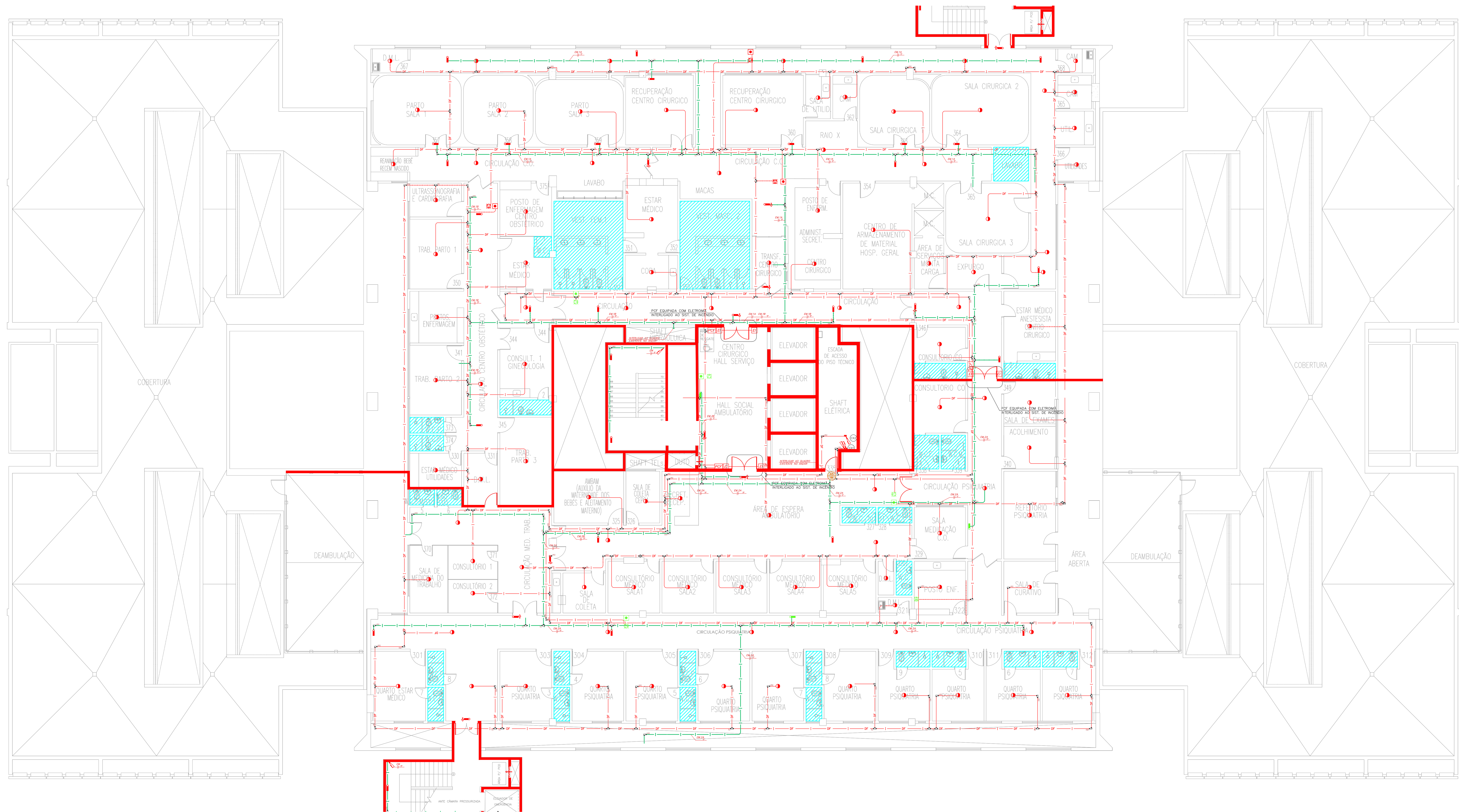
1 HOSPITAL GERAL DE TAIAPÁS PROJETO DE INSTALAÇÃO DO SISTEMA DE INCÊNDIO PLANTA BAIXA - 3º PAVIMENTO ESCALA: 1:100 METRO
