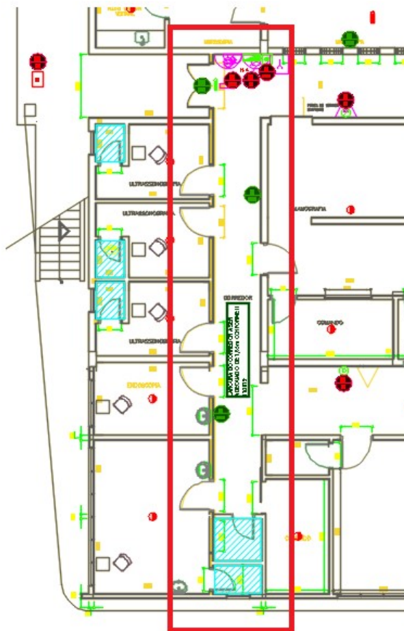
Figura 14 – EDIFÍCIO 26 – PAVIMENTO TÉRREO –Demolição/reconstrução linha de parede do corredor ultrassonografia
