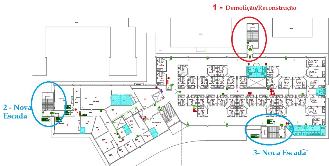
Figura 43 – EDIFÍCIO 27 – PAVIMENTO SUPERIOR– Novas escadas
