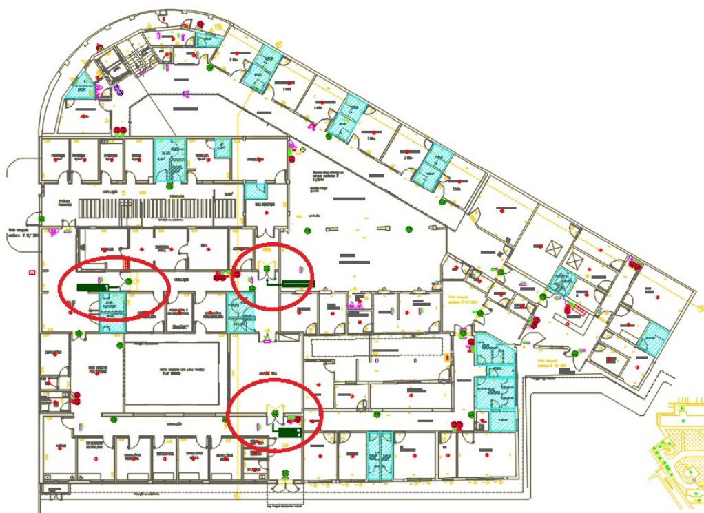
Figura 11 – EDIFÍCIO 10 – PAVIMENTO TÉRREO - Inversão sentido de porta
