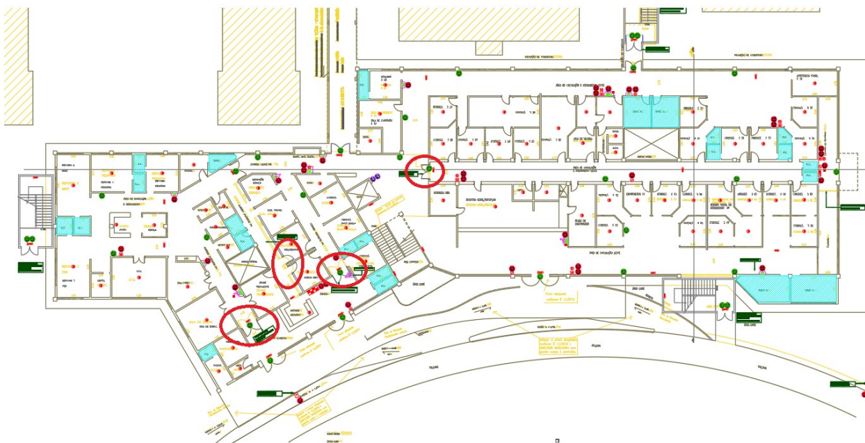
Figura 7 – EDIFÍCIO 27 - PAVIMENTO TÉRREO- Inversão sentido de porta
