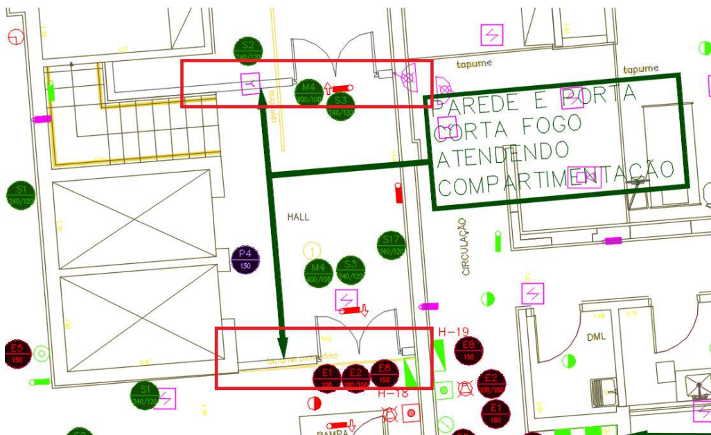
Figura 19 – HOSPITAL – 1º PAVIMENTO – Construção de parede para compartimentação
