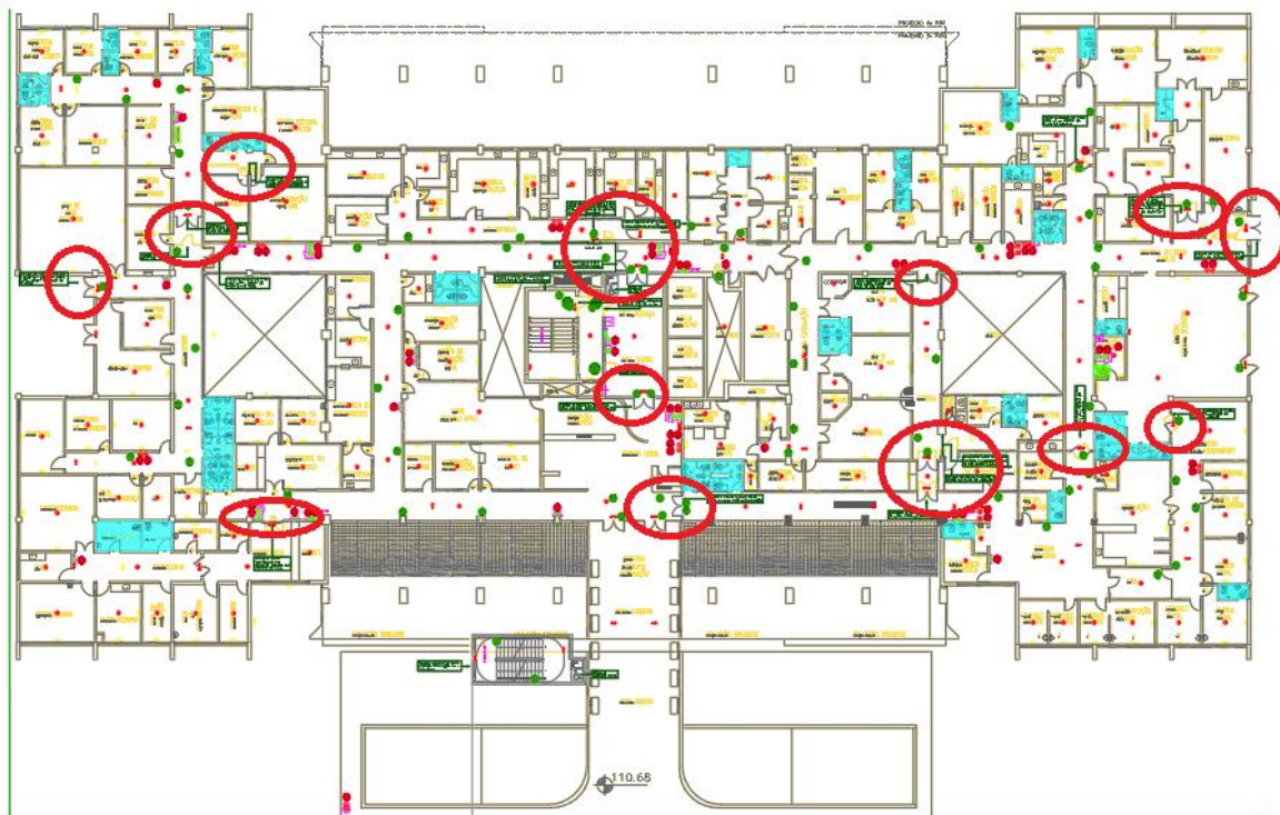
Figura 2 – 2º PAVIMENTO – Inversão no sentido de porta/Remoção e instalação de nova
