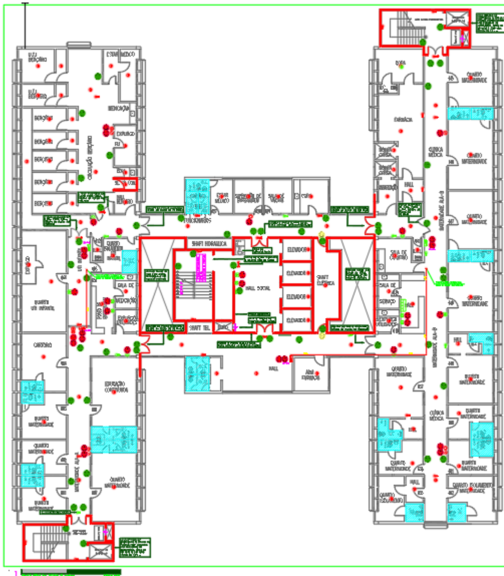
Figura 13 – 6º PAVIMENTO – Paredes corta-fogo (vermelho)
