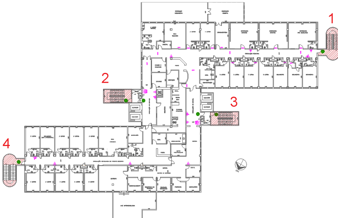
Figura 3 – LEVANTAMENTO 1º PAVIMENTO – ESCADAS A DEMOLIR/RECONSTRUIR
