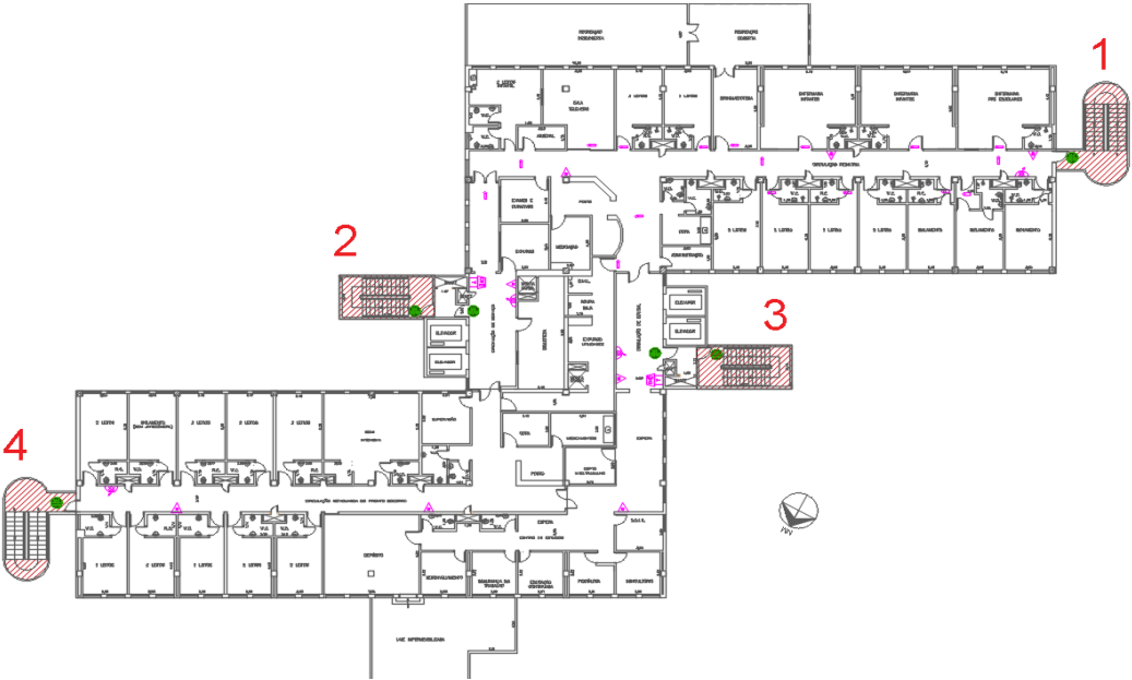
Figura 7 – ÁREA PREVISTA DE DEMOLIÇÃO DA ESCADA 4
