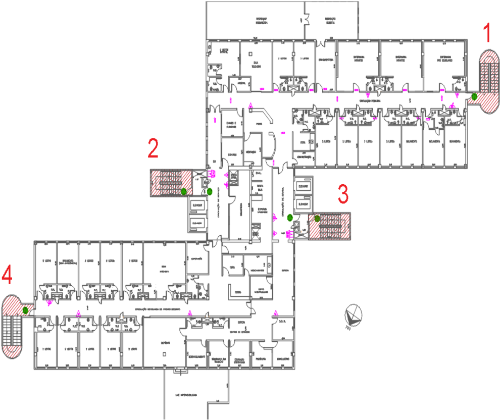
Figura 6 – ÁREA PREVISTA DE DEMOLIÇÃO DA ESCADA 1
