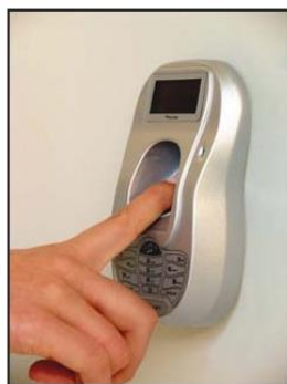
Figura 23: Controle de Acesso Biométrico
