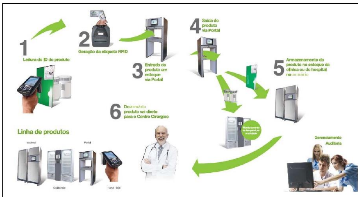
Figura 25 – Fluxo do portal RFID
