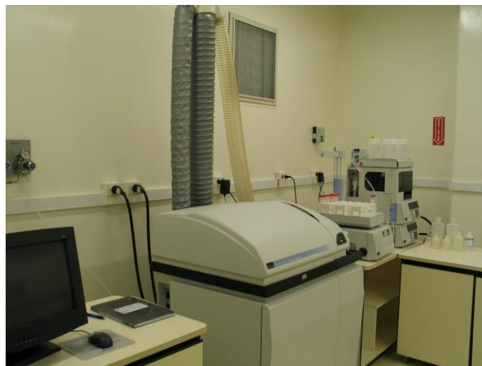
Laboratório com controle de material particulado para Espectrometria de Massa (ICP-MS) para determinação de metais tóxicos
