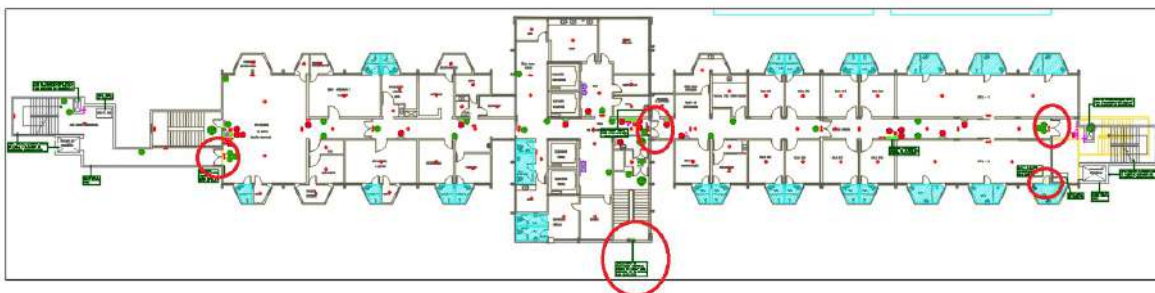
Figura 5 –2º PAVIMENTO - Inversão sentido de porta e remoção/Instalação de nova porta e janela
