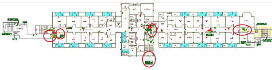
Figura 7 –4º PAVIMENTO - Inversão sentido de porta e remoção/Instalação de nova porta e janela
