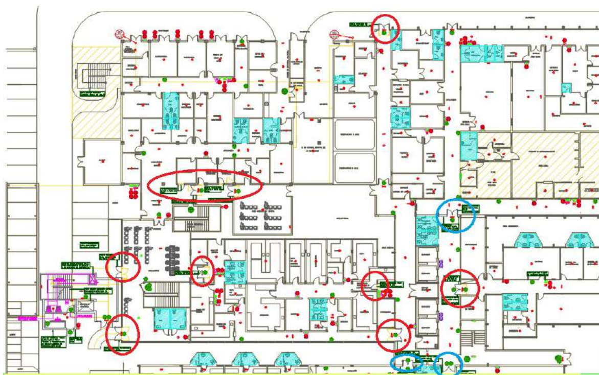
Figura 1 –PAVIMENTO TÉRREO – parte 1/3 - Inversão sentido de porta e remoção/Instalação de nova porta
