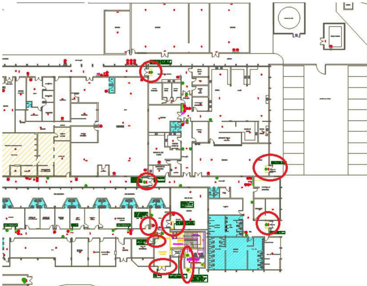
Figura 2 –PAVIMENTO TÉRREO – parte 2/3 - Inversão sentido de porta e remoção/Instalação de nova porta
