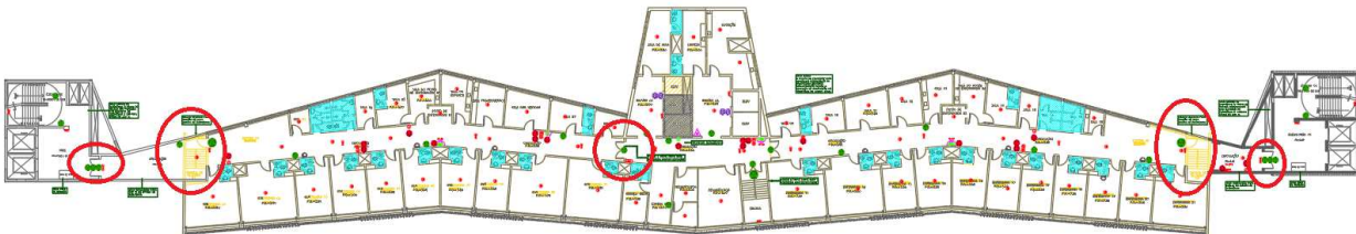
Figura 6 –HOSPITAL – 4ºPAVIMENTO – Remoção e instalação de novas portas
