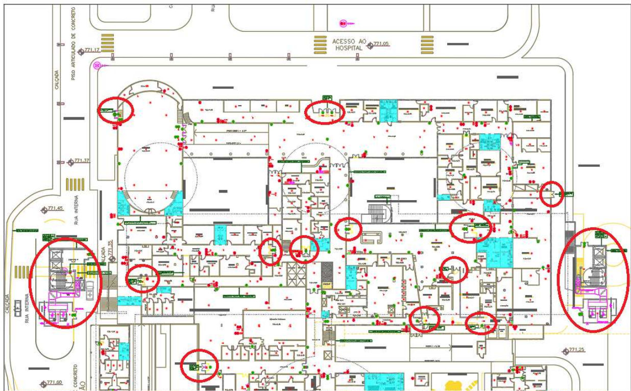
Figura 1 – TÉRREO – Inversão no sentido de portas/Remoção e instalação de novas portas
