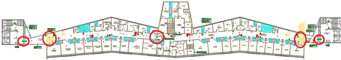
Figura 4 –HOSPITAL – 2ºPAVIMENTO – Remoção e instalação de novas portas
