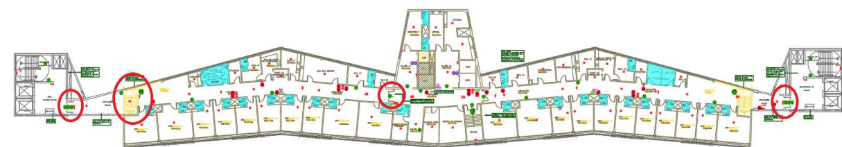
Figura 8 –HOSPITAL – 6ºPAVIMENTO – Remoção e instalação de novas portas
