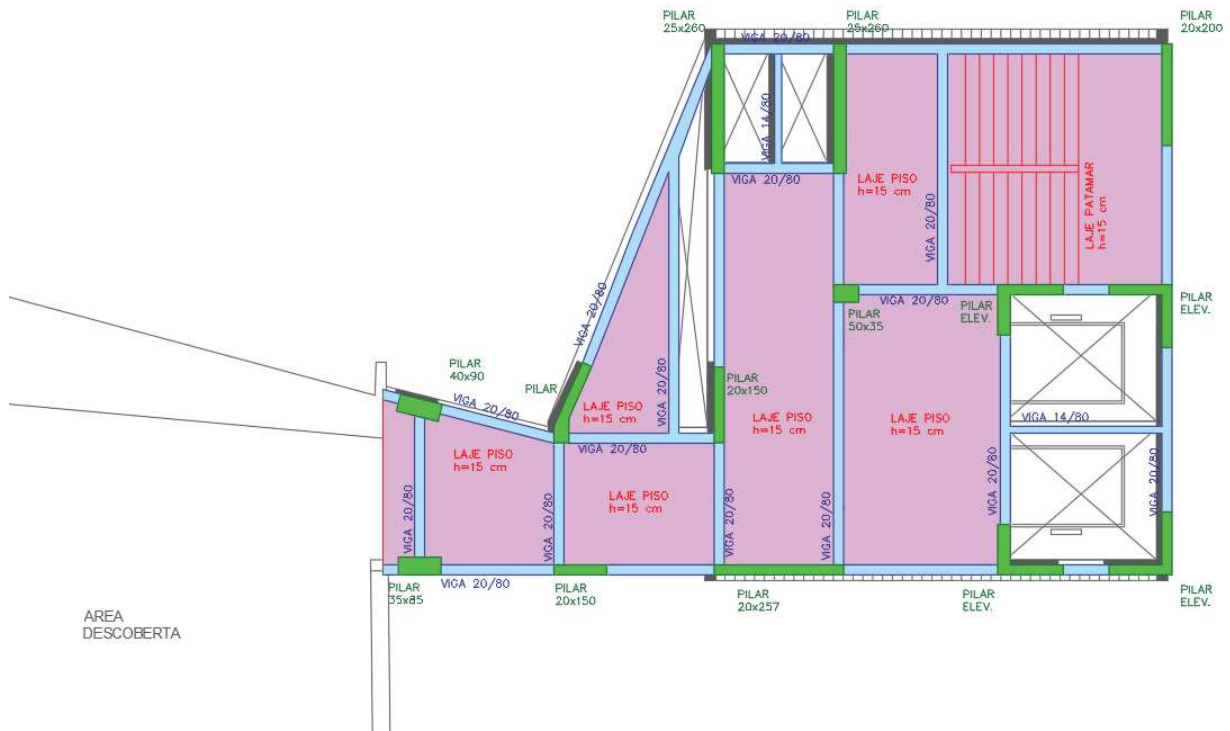
Figura 67 – NOVO CONJUNTO EMERGÊNCIA 01 – 10º PAVIMENTO – Croqui Estrutura
