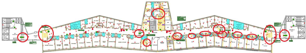
Figura 11 –HOSPITAL – 9ºPAVIMENTO – Remoção e instalação de novas portas
