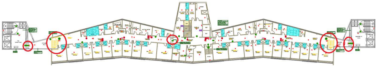
Figura 10 –HOSPITAL – 8ºPAVIMENTO – Remoção e instalação de novas portas
