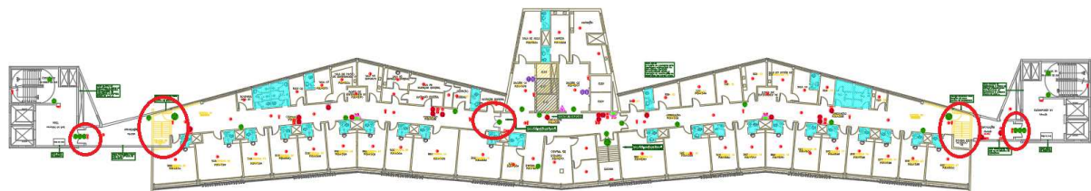
Figura 7 –HOSPITAL – 5ºPAVIMENTO – Remoção e instalação de novas portas
