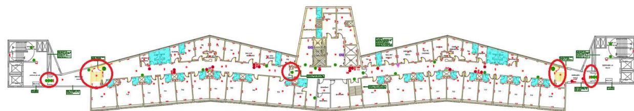
Figura 9 –HOSPITAL – 7ºPAVIMENTO – Remoção e instalação de novas portas
