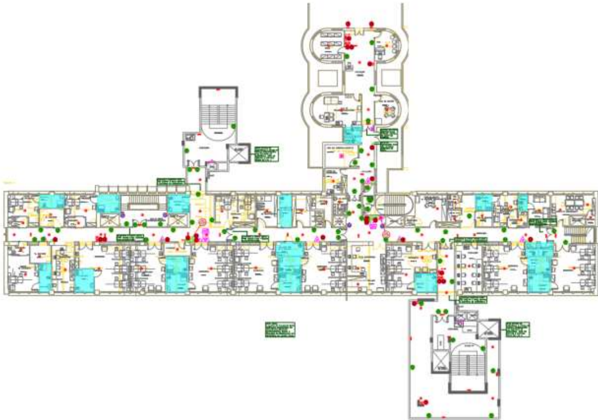
Figura 19 – 9º PAVIMENTO – Inversão no sentido de porta/Remoção e instalação de novas portas
