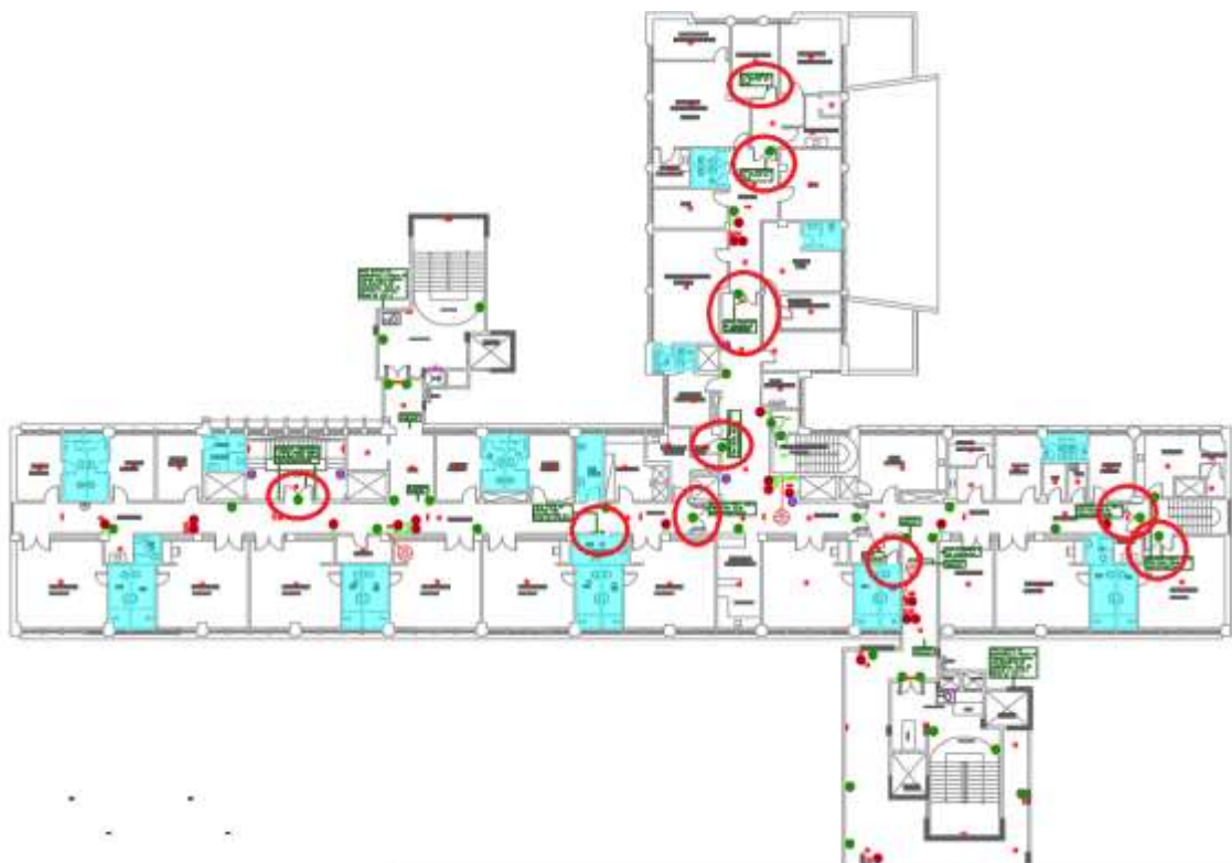
Figura 13 – 3º PAVIMENTO – Inversão no sentido de porta/Remoção e instalação de novas portas
