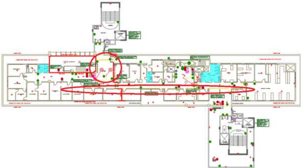
Figura 21 – 11º PAVIMENTO – Inversão no sentido de porta/Remoção e instalação de novas portas
