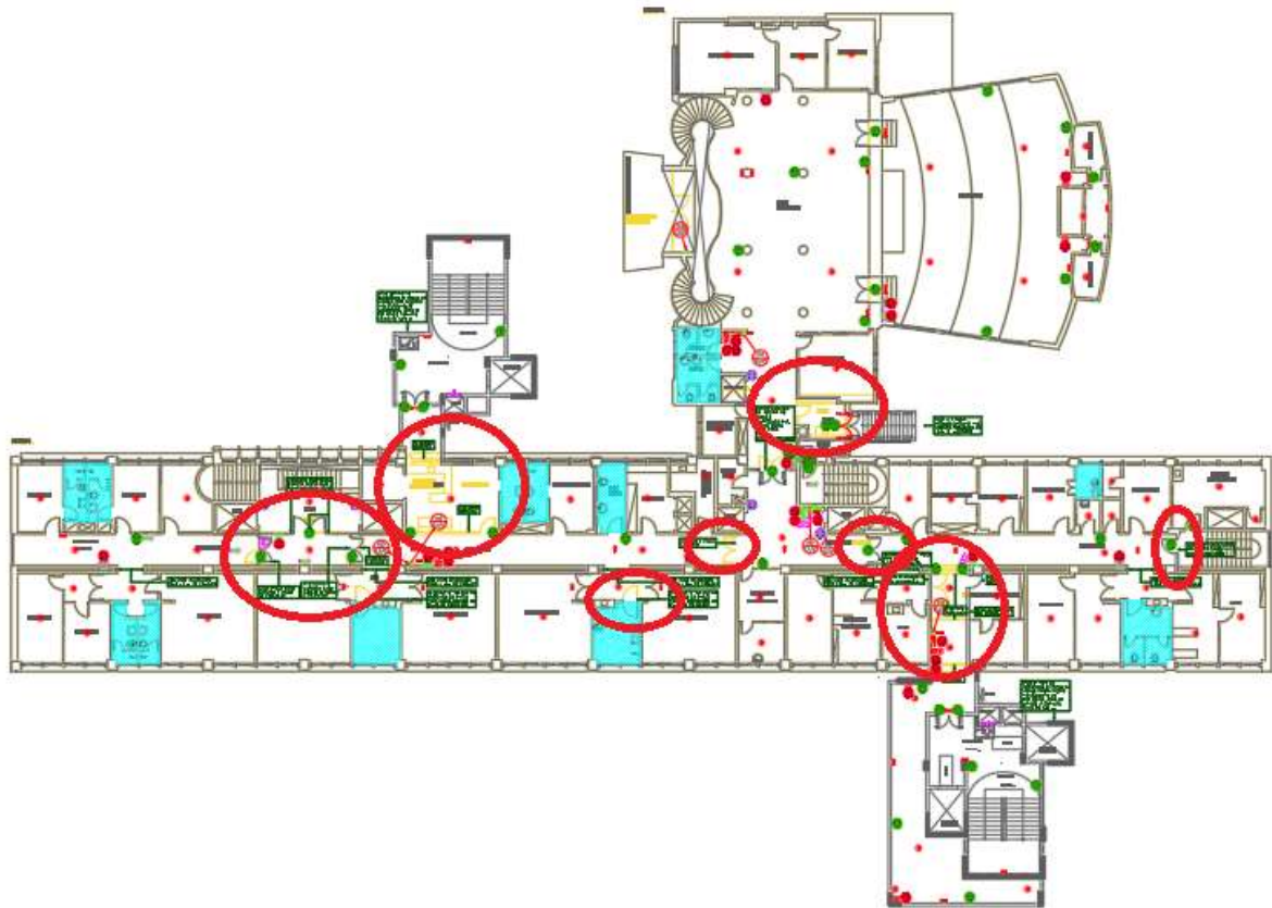
Figura 12 – 2º PAVIMENTO – Inversão no sentido de porta/Remoção e instalação de novas portas
