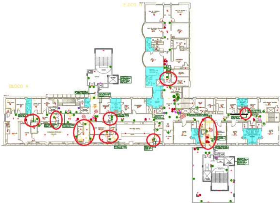
Figura 17 – 7º PAVIMENTO – Inversão no sentido de porta/Remoção e instalação de novas portas
