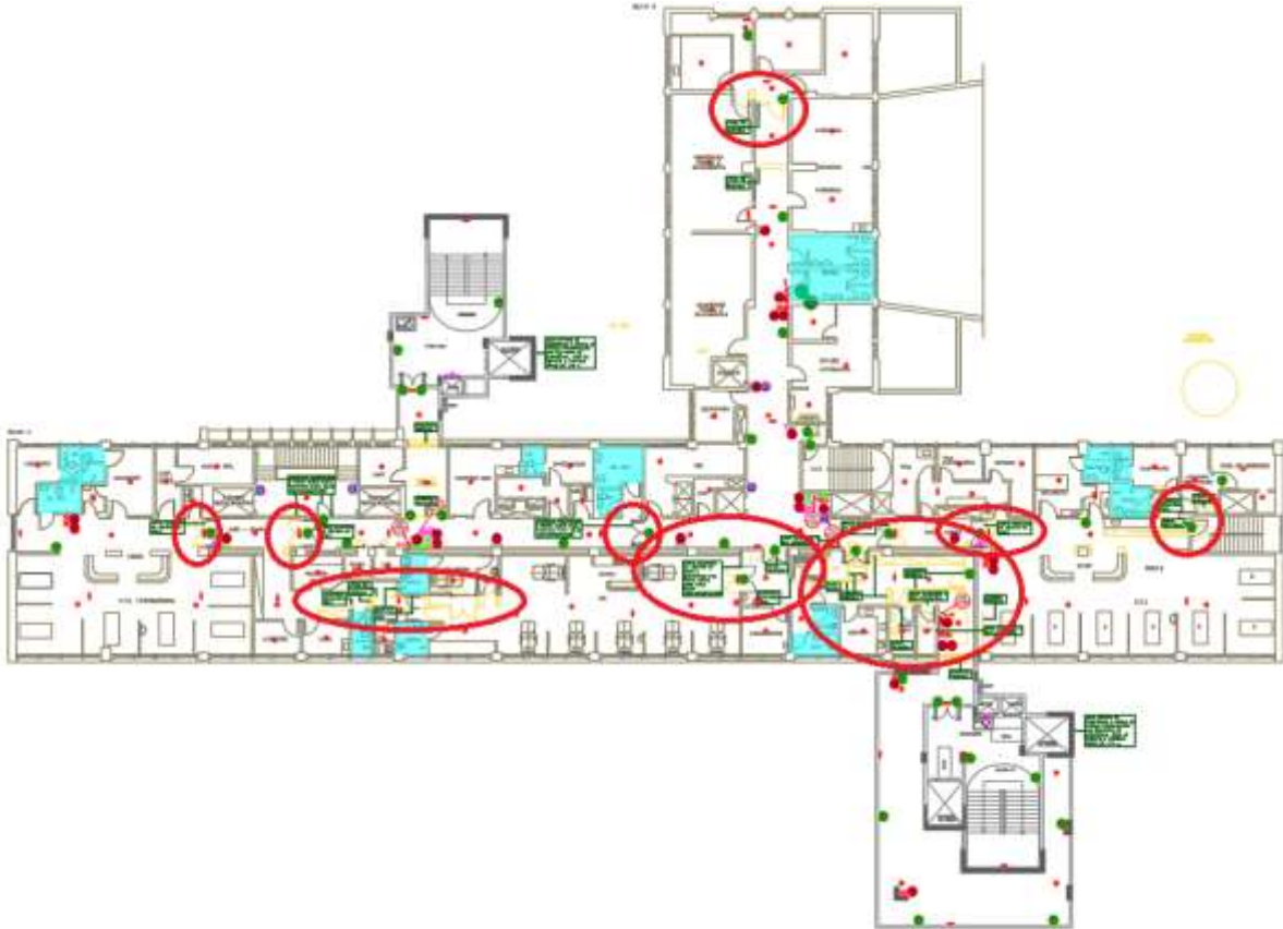
Figura 14 – 4º PAVIMENTO – Inversão no sentido de porta/Remoção e instalação de novas portas
