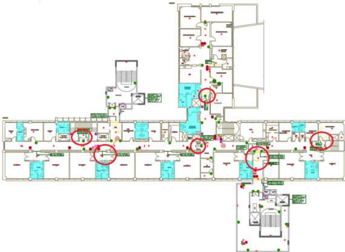
Figura 15 – 5º PAVIMENTO – Inversão no sentido de porta/Remoção e instalação de novas portas
