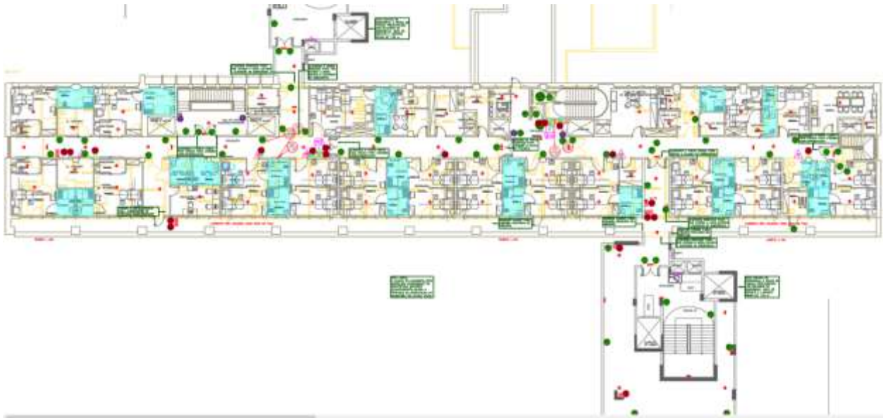
Figura 20 – 10º PAVIMENTO – Inversão no sentido de porta/Remoção e instalação de novas portas
